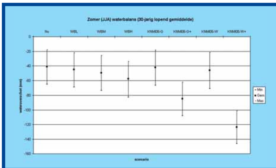
Afb. 2: Het gemiddelde, het maximum en het minimum van het 30-jarig lopend gemiddelde watertekort in de zomer voor de huidige situatie en voor het zichtjaar 2050 voor de WB21- en KNMI'06-scenario's.
