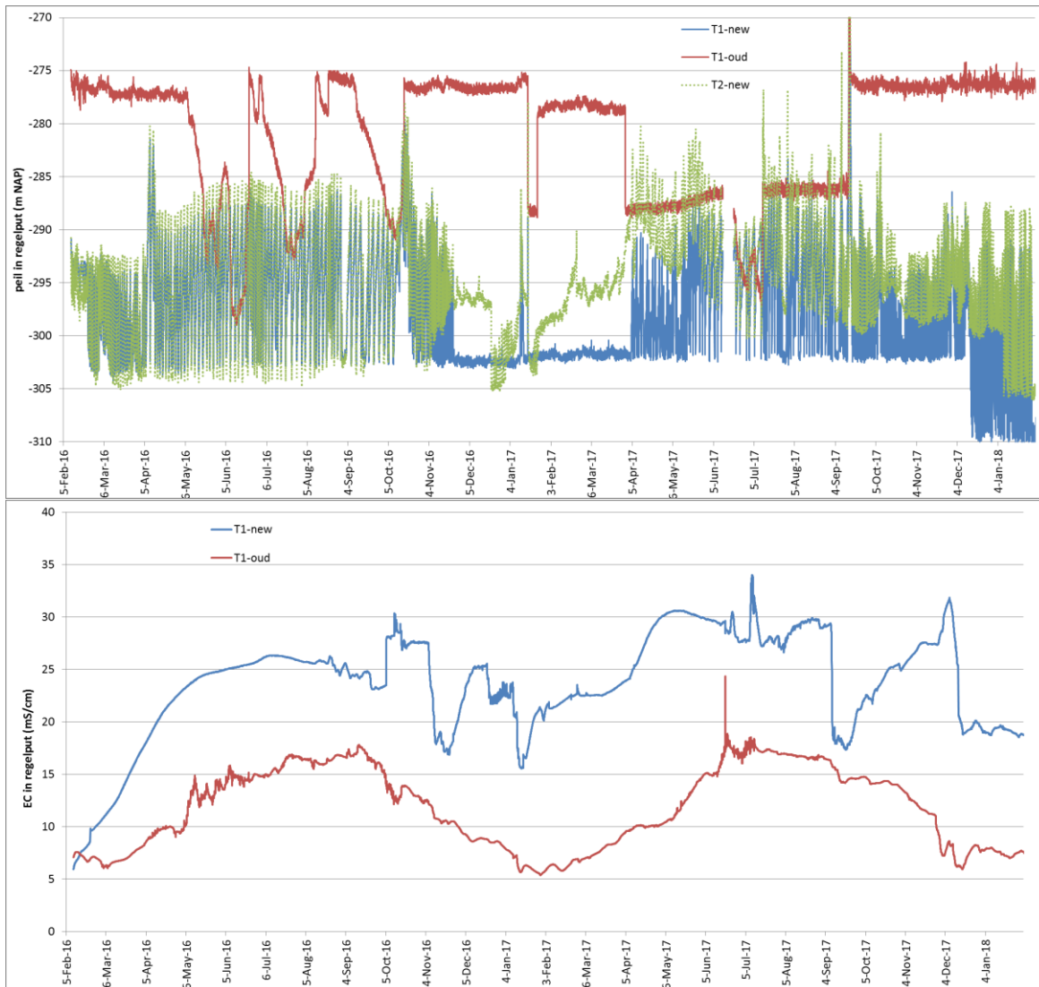
Figuur 4.23 a. het drainagepeil in de regelput (boven) en b. het zoutgehalte van de drainageafvoer (onder) voor de ondiepe traditionele drain voor T1 (T1 oud) en de nieuwe diepere drains T1-new en T2-new.
