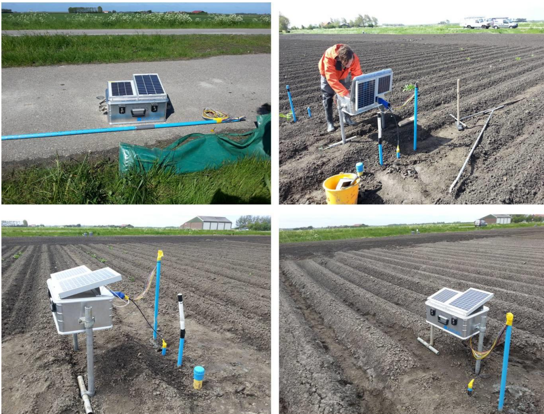
Figuur 4.9 Installatie van de ResProbes op 22 mei 2013
