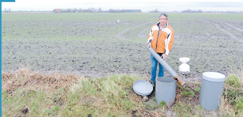
Rien van de Hoek met een van de kokers waarmee hij de peilgestuurde drainage regelt. Links achter hem een meetpunt voor zoute lavel.
