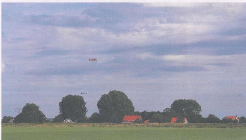
Het HEM-systeem onder de helikopter meet de elektrische geleidbaarheid van de ondergrond gecombineerd met die van het grondwater.
