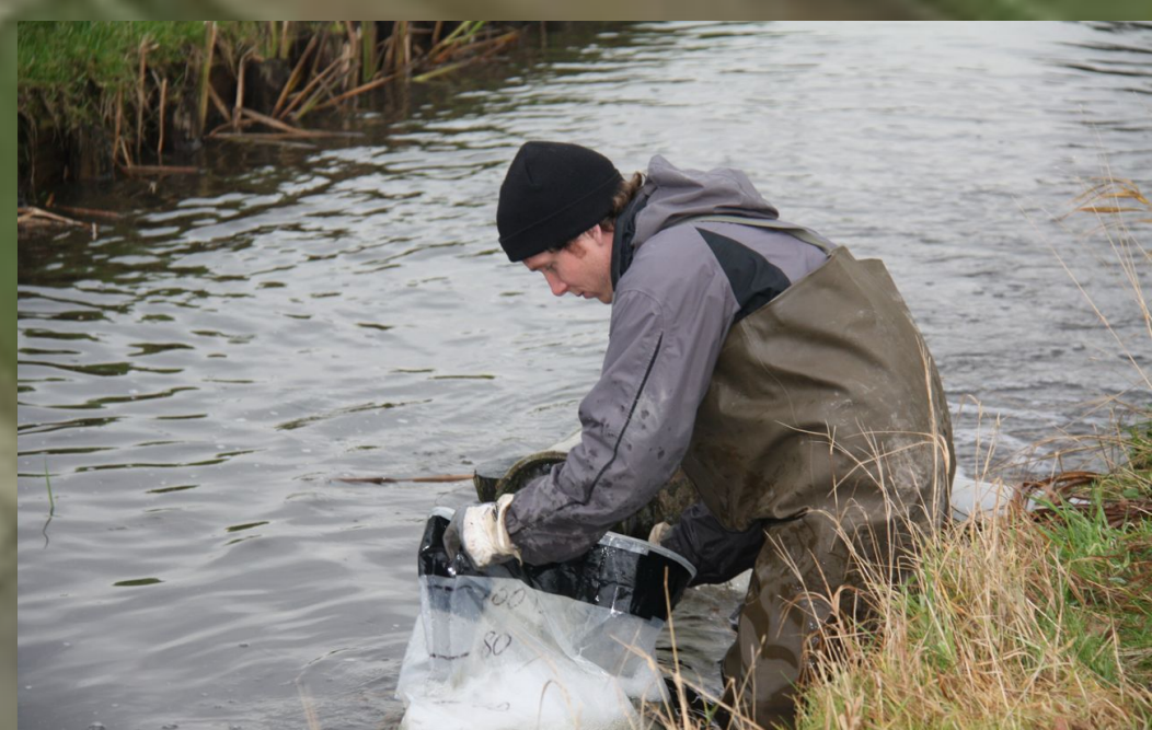
Fig 3: Low-tech inlaatmeting (bleek ongeveer dubbel de eerder aangenomen hoeveelheid)
