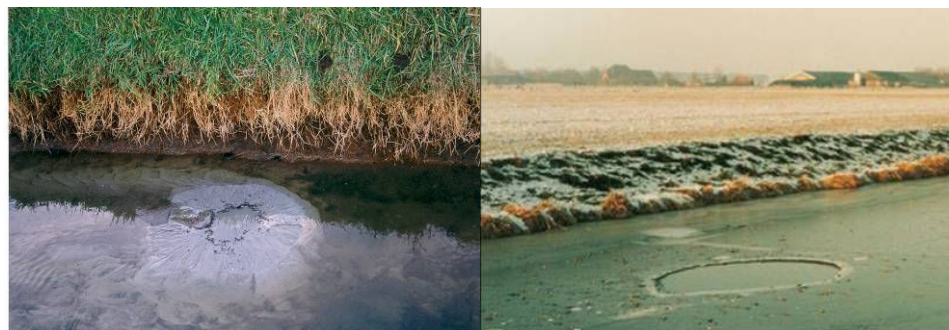
Figuur 1.3 Links: zandvulkaan die ontstaat rondom een wel: door de hoge intensiteit van de kwel wordt zand uit het watervoerende pakket naar het oppervlak getransporteerd. Rechts: wellen bevroren door de hoge kwelintensiteit en temperatuur (ongeveer 12 graden) vaak niet dicht.
