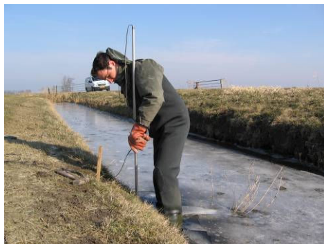
Figuur 1.6 Foto's: EC-T prikstokmetingen (in de sloot en in het perceel)
