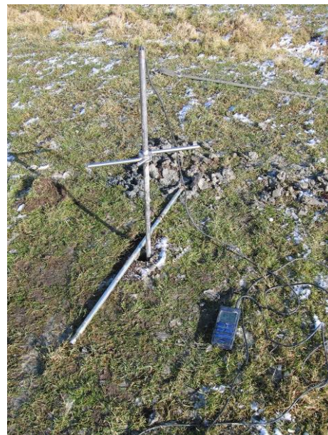
Figuur 1.6 Foto's: EC-T prikstokmetingen (in de sloot en in het perceel)
