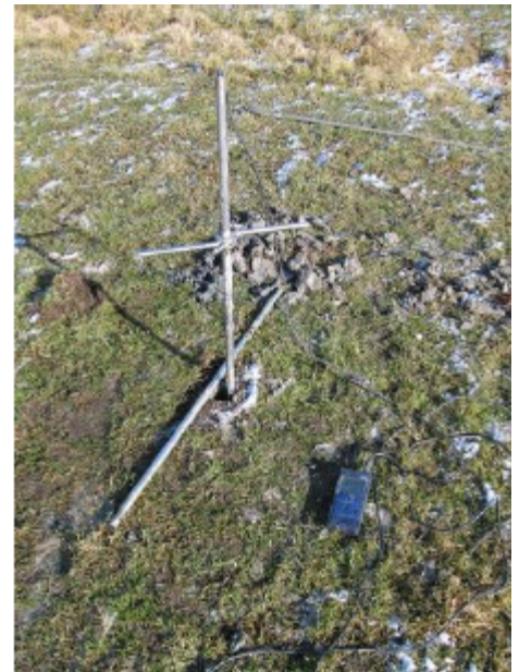
Figuur 36: De T-EC prikstok in het veld.
