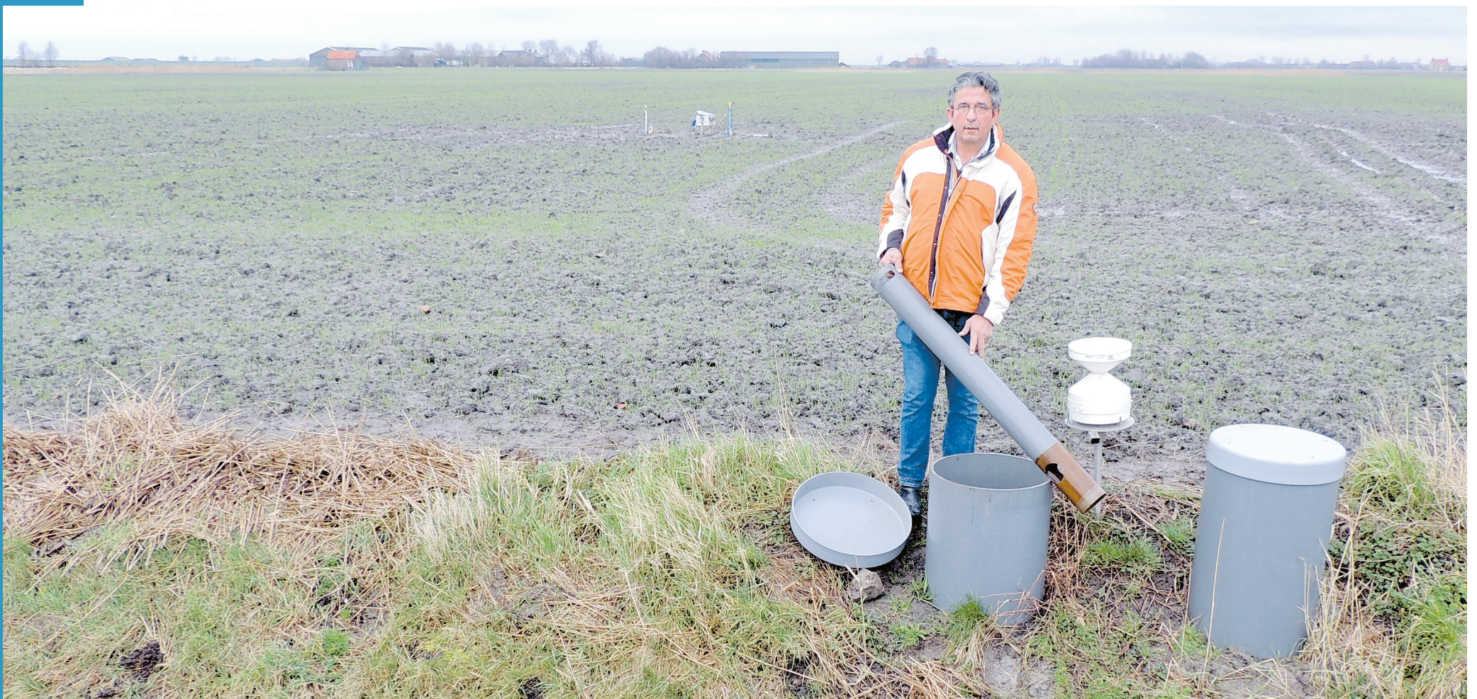
Rien van de Hoek met een van de kokers waarmee hij de peilgestuurde drainage regelt. Links achter hem een meetpunt voor zoute kwel.
