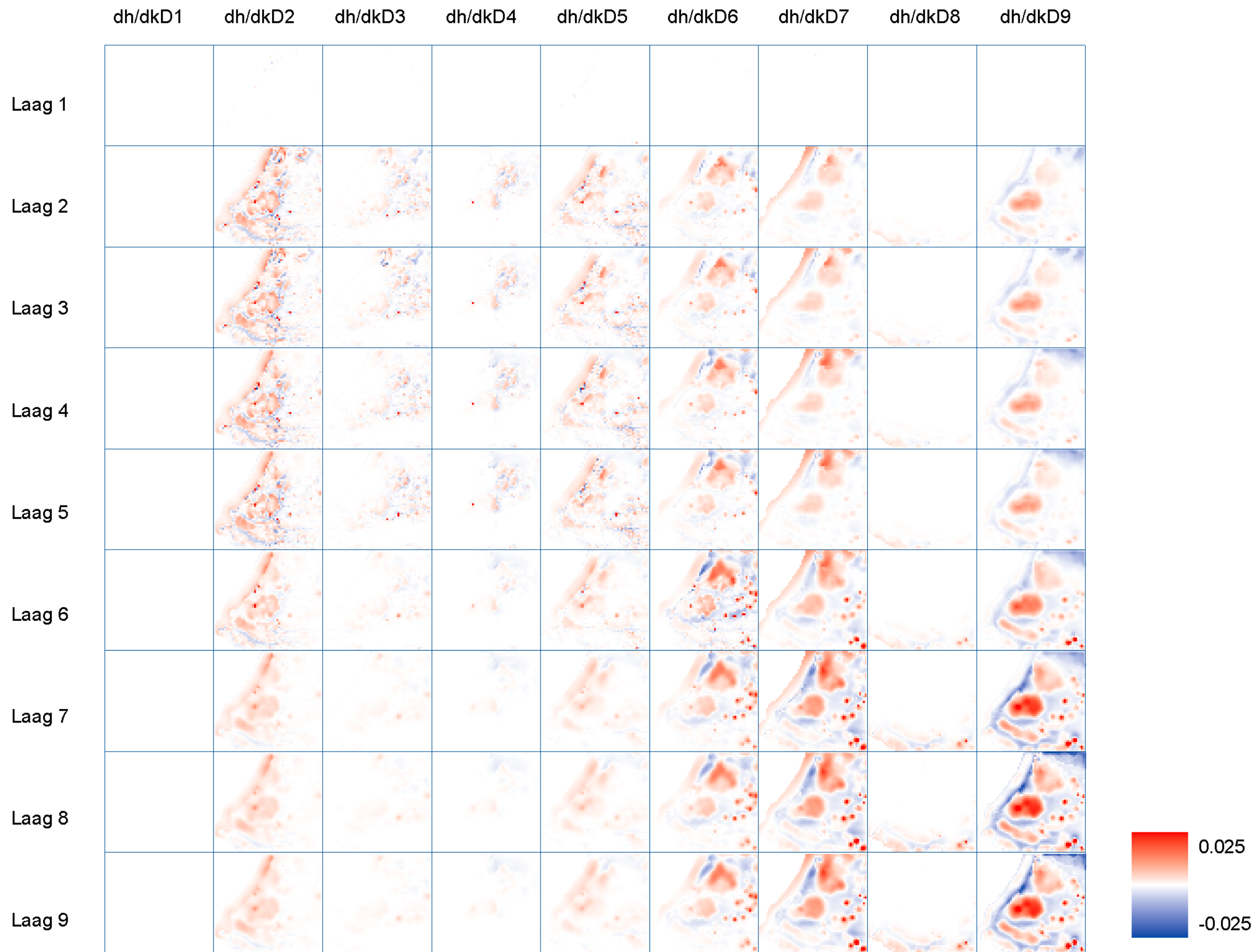
Figuur 8 - Modelgevoeligheid voor verandering van de kD-waarden: in kolom 1 als gevolg van een fractionele verhoging van de kD in modellaag 1, in kolom 2 van de kD in modellaag 2, enzovoort. Daaronder is steeds voor elke modellaag de verandering in de zoetwaterstijghoogte als gevolg van deze verandering afgebeeld. De kleur rood resp. blauw geven aan dat de zoetwaterstijghoogte omhoog resp. omlaag gaat als de kD wordt verhoogd.
