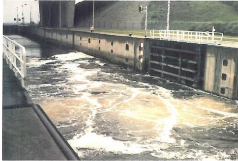
Foto 16. Meetsituatie Proef 2a, Hollands Diep-zijde (uitwisselen, zoete voorhaven / zoute kolk, luchtbellenscherm)
