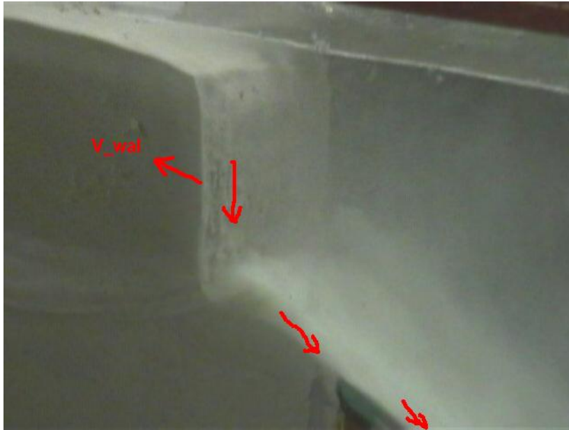
Foto 6 Modelproef bressen talud in fijn zand
